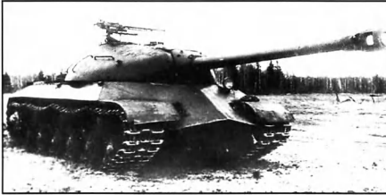
Второй опытный ИС-3 с формой корпуса "щучий нос"
