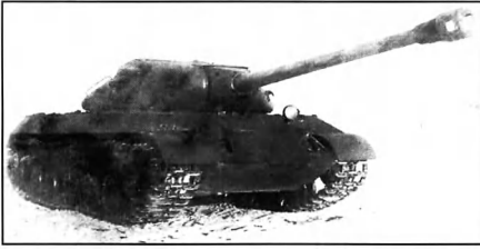
Первый опытный ИС-3 еще с лобовой деталью по типу Т-34
