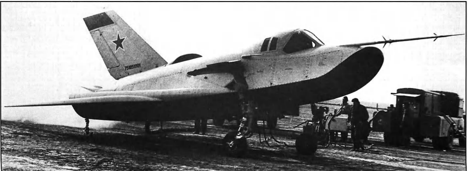
Самолет-аналог "105.11" на колесном шасси
